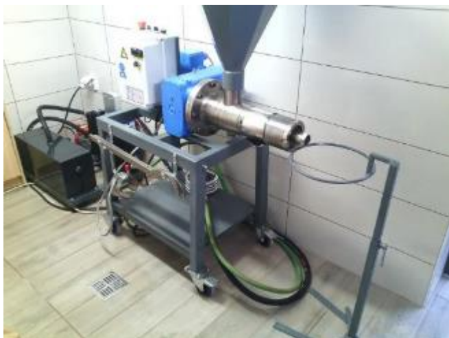
Slika 5: Vijačna stiskalnica AIS P 95, moči 4 kW omogoča večji delovni učinek pri stiskanju soje, primer mikro oljarne na kmetiji (Fotografija: V. Ježič)
