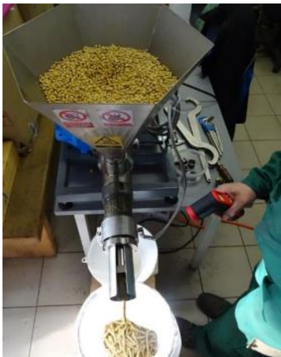
Slika 65: Merjenje delovne temperature stiskalnice med stiskanjem soje na stiskalnici AIS P 60 (Fotografija: T. Poje)
