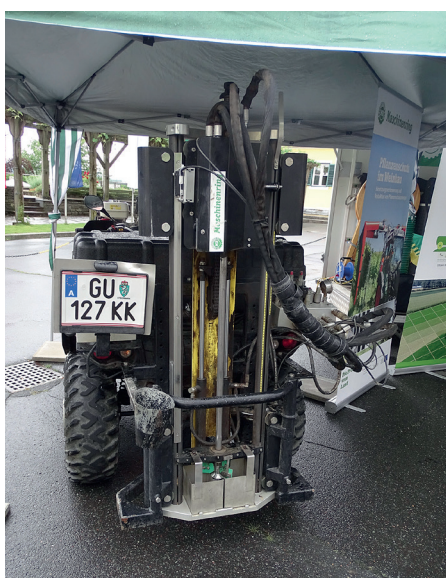
Naprava za odzemanje vzorcev tal Wintex na motornem štirikolesniku. Avstrijski Strojni krožki s takimi napravami izvajajo storitve vzorčenja in analiz talnih vzorcev.
