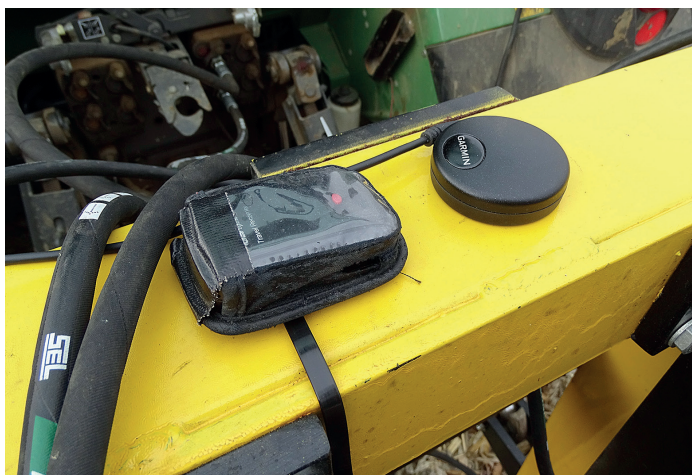
Dva GPS sprejemnika za določevanje geolokacije za posamezen odvzem podzorca tal in meritve specifičnega upora tal.
