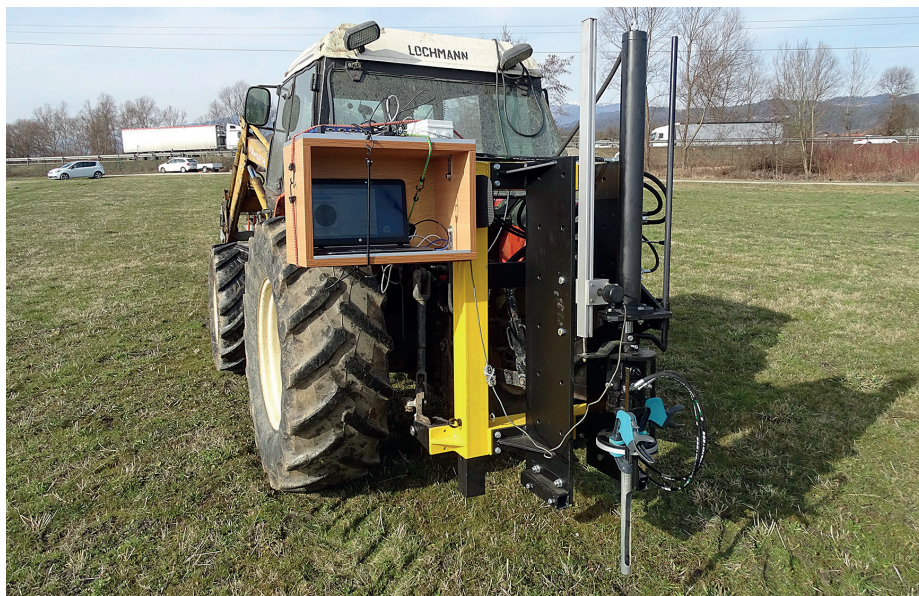
Naprava za ugotavljanje specifičnega upora tal in odvzem vzorcev tal razvita na Kmetijskem inštitutu Slovenije
