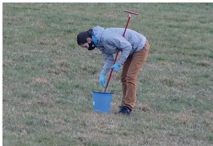
Ročno vzorčenje tal s pomočjo sonde za jemanje talnih vzorcev
