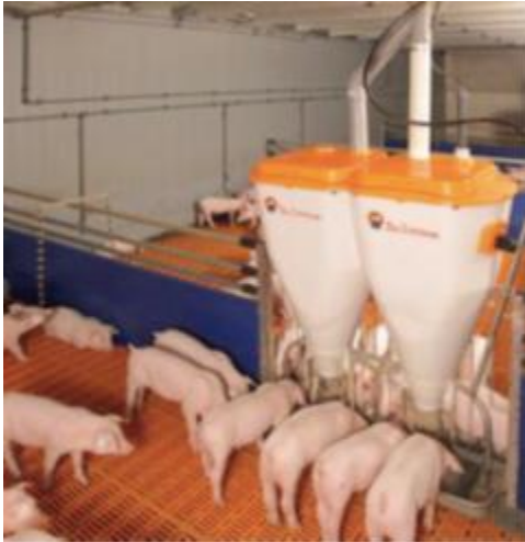
Slika : Sistem za krmljenje po suhem postopku porabi manj energije za transport krme, kot sistemi za krmljenje po mokrem postopku (vir: Big Dutchman)
