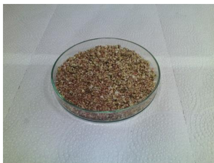
Slika: Granulat klasinca, velikost delcev 1 – 5 mm
