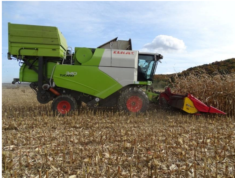
Slika: Kombajn za spravilo koruznega zrnja Claas Tucano 340 z dodatnim sklopom za zajem klasincev (prigrajen na zadnjem delu kombajna zgoraj)
