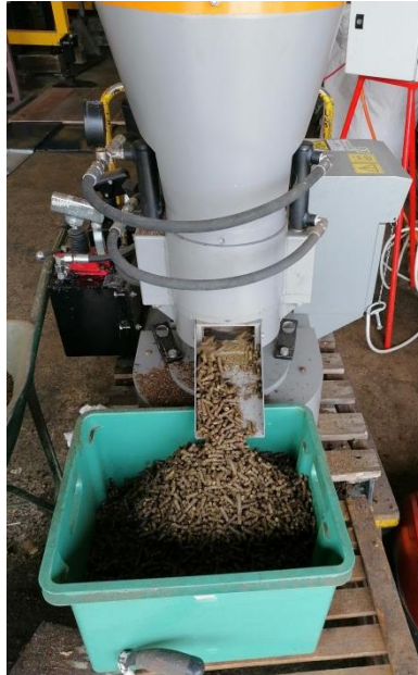
Slika : Stroj za peletiranje kmetijske biomase s horizontalno matrico (vir: Oddelek za kmetijsko tehniko in energetiko, Kmetijski inštitut Slovenije)
