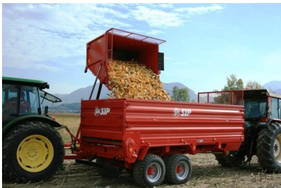
Slika : Praznjenje zalgovnika obiralnika koruze v storžih, transport storžev se opravlja s prikolicami s povišanimi stranicami
