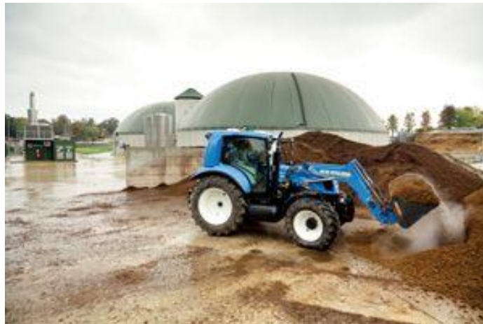
Slika : Traktor, ki ga lahko poganja metan ali biometan (vir: New Holland)
