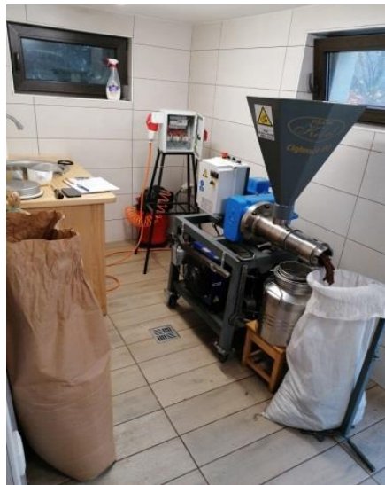
Slika : Mehanska ekstrakcija semena oljnic s kontinuiranim postopkom z vijačno izvedbo stiskalnice v majhni oljarni na kmetiji, merilna oprema za ugotavljanje porabe električne energije je postavljena za stiskalnico
