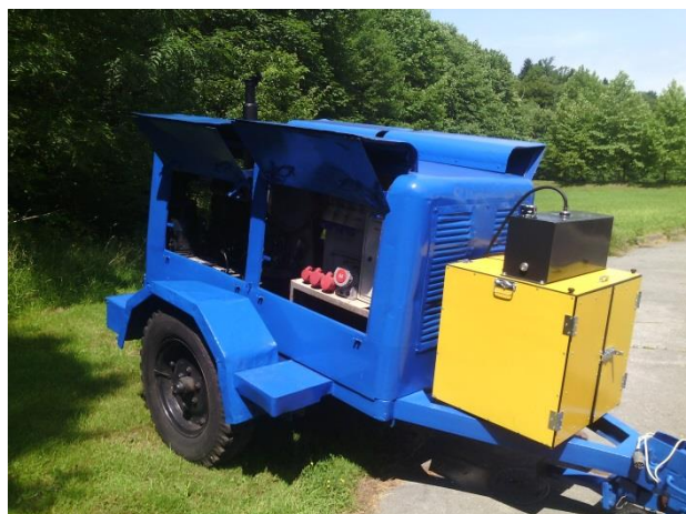
Slika : Nadgrajena (angl. Retrofitting) starejše verzije dizel električnega agregata moči 40 kWe, dizel motor agregata poganja očiščeno jedilno olje iz modula AIS - OIL ELGENER 2. Nadgradnja starejših dizelskih motorjev agregatov ali kogeneratorjev z modulom AIS - OIL ELGENER 21 omogoča nižje emisije TGP in ekonomičnost zaradi zamenjave mineralnega dizelskega goriva z očiščenim odpadnim jedilnim oljem, na prednjem delu dizel električnega agregata moči je vgrajen modul za sistem AIS OIL MOBIL 19 (rumena barva ohišja), ki omogoča da dizel električni agregat za pogon uporablja očiščeno odpadno jedilno olje ter proizvodnjo zelene električne energije.
