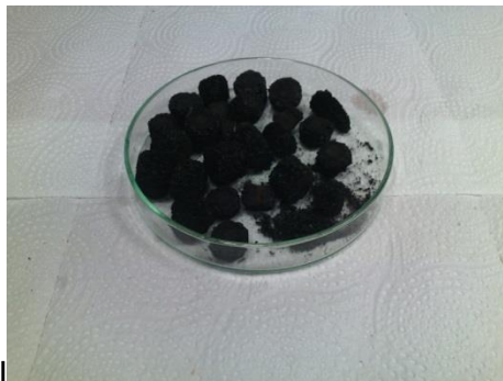
Slika: Granulat klasinca po opravljenem postopku pirolize
