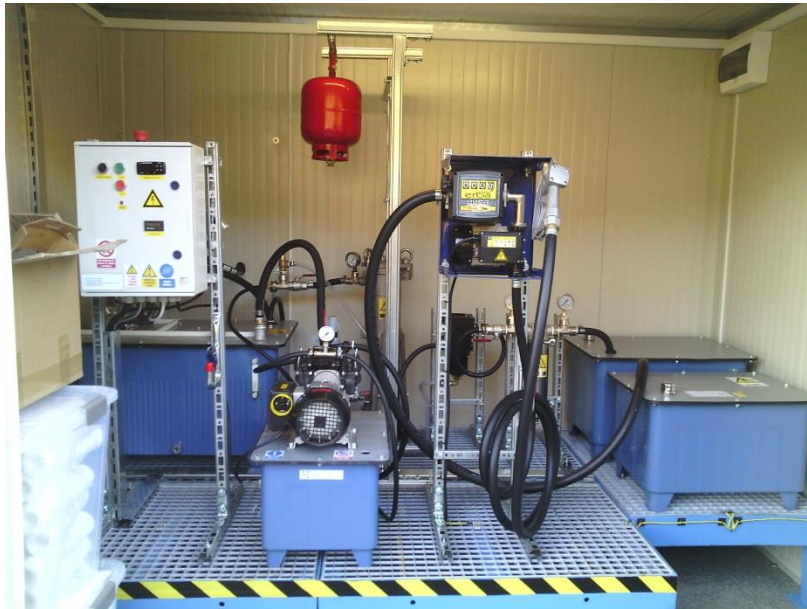
Slika : Pogled v notranjost modulare postaje AIS OIL CLEAN 19 za čiščenje odpadnih jedilnih olj (vir: Kmetijski inštitut Slovenije, Oddelek za kmetijsko tehniko in energetiko)
