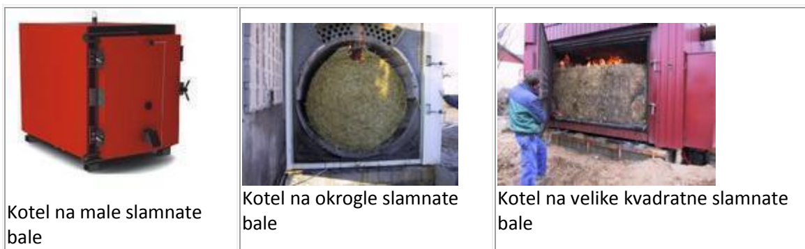
Slika : Kotli na različne oblike bal iz odpadne kmetijske biomase
