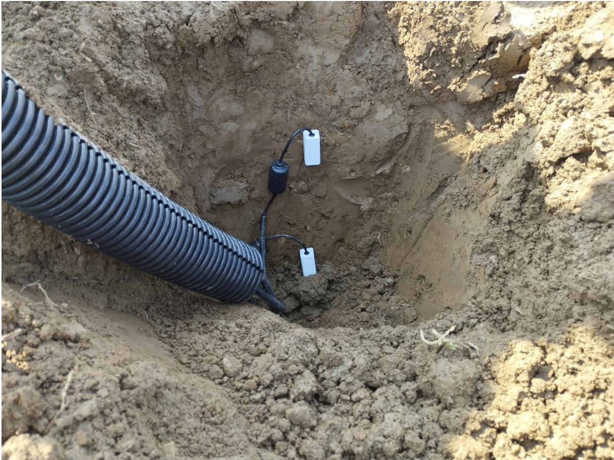
Slika 1: Nameščeni senzori za spremljanje stanja vlažnosti tal, avtor M.Č. (slika 1.jpg)
