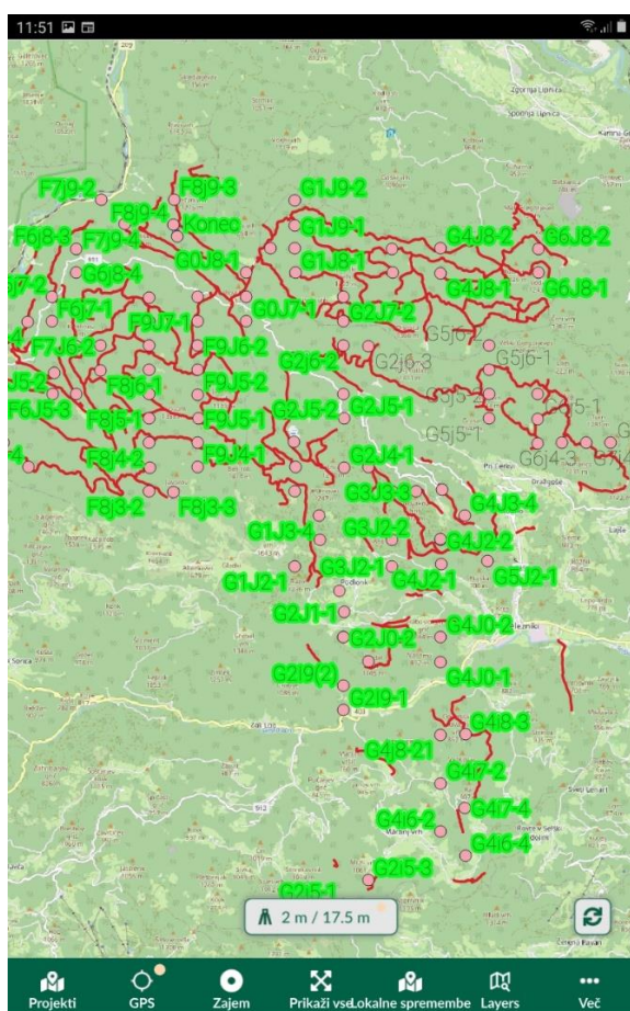
Slika 26: Na sliki je zaslon tabličnega računalnika z odprto aplikacijo Merginmaps. Na zaslonu so prikazane točke in številke ploskev, zelena barva prikazuje že izmerjene ploskve, točke brez barve so ploskve na katerih je meritve še potrebno izvesti.
