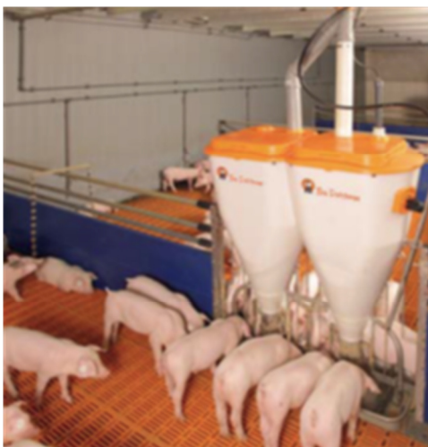
Slika 2: Sistem za krmljenje po suhem postopku porabi manj energije za transport krme, kot sistemi za krmljenje po mokrem postopku (vir: Big Dutchman)
