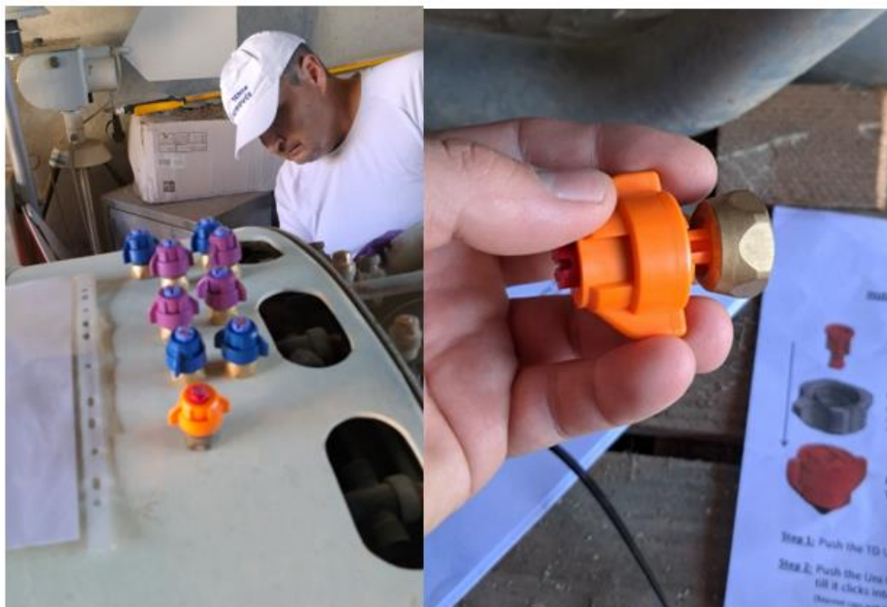
Slika 11: Nameščanje šob na šobni venec hmeljarskega pršilnika (levo) in sestavljanje šobe Agrotop TD (desno)
