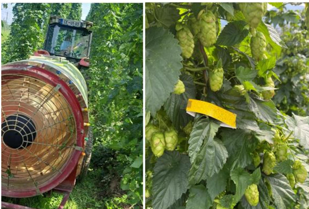
Slika 12: Pršenje hmelja z Agrotop TD, nameščenimi na pršilniku (levo) in nameščen vodo-občutljivi listič na hmelju na višini 6 m (desno)
