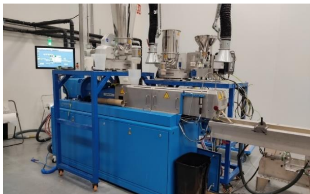
Dvopolžni ekstruder za pripravo kompozita (COPERION)
