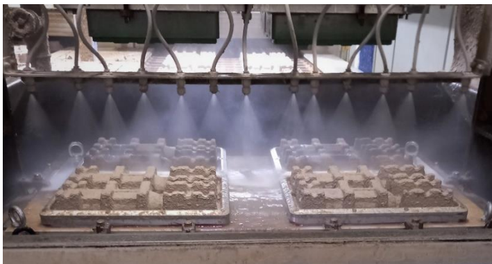
Oblikovanje embalaže in prenos na trak za sušenje
