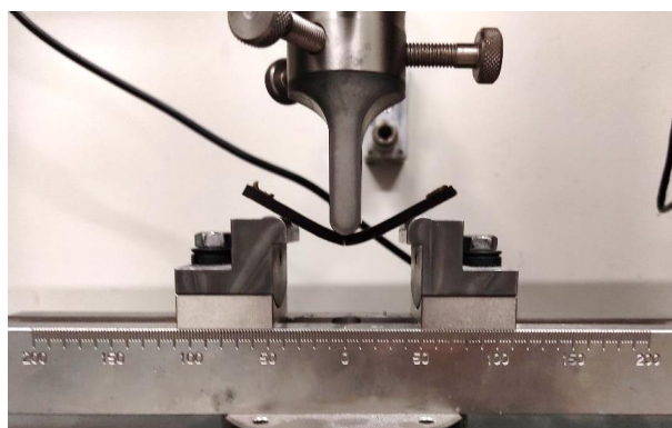
Preverjanje mehanskih lastnosti BioTHOP kompozita
