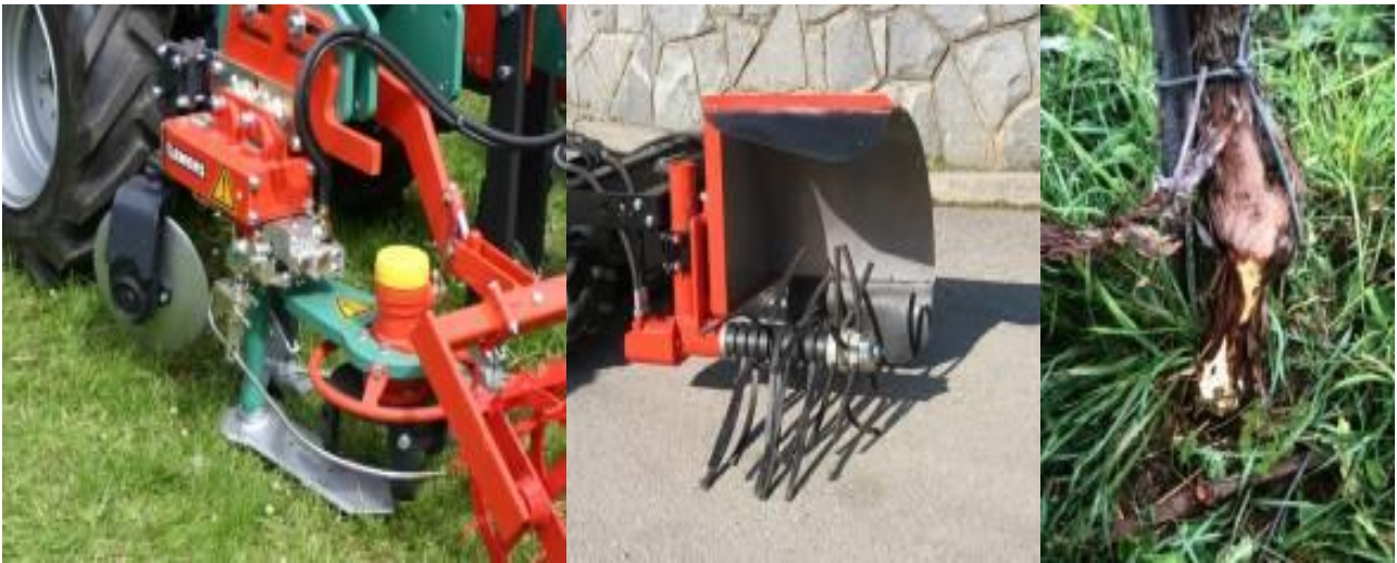
Slika 7: Podrezovalnik plevelov (levo) in prirejen pletvenik (na sredini) za mehansko zatiranje plevelov v vrsti ter poškodbe na trsu (desno) zaradi neustrezne izbire mehanizacije (Foto: S. Vršič)
