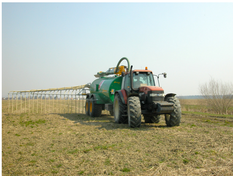
Slika 13: Gnojenje z gnojevko tesno pri tleh zmanjša izgube amoniaka
