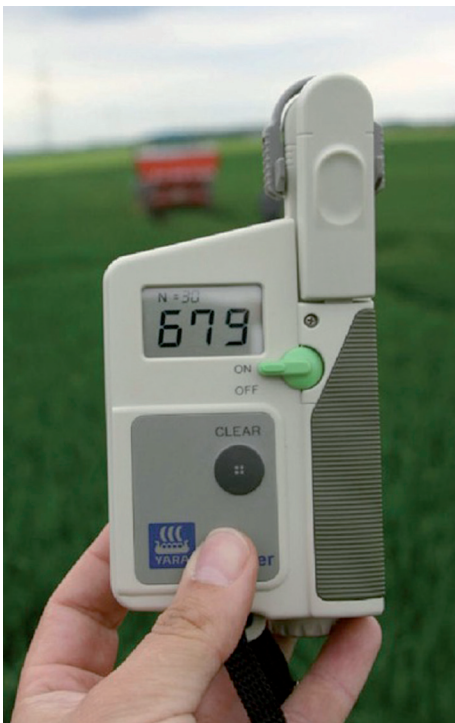
Slika 8: Pimer merilca koncentracije dušika na osnovi klorofila
