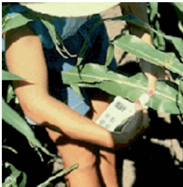
Slika 5: Meritve obarvanosti listov s klorofilomerom (N-tester ali SPAD meter)
